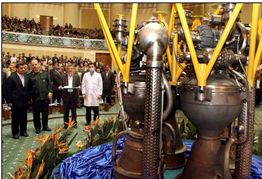
Figur 6.12 Framvisning av motoren til Simorghs første trinn 3. februar 2010. Motoren består av et cluster av fire No-dong-motorer. (Bilde: Scanpix - AP Photo.)
