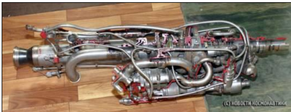
Figur 6.11 Turbopumpen til en styremotor til BM-25/R-27. (Bilderettigheter: Novosti Kosmonavtiki. Gjengitt blant annet i [134].)
