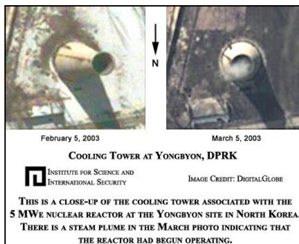
Figur 4.2 Kommersielle satellittbilder fra vinteren 2003 viser damp fra kjøletårnet til Reaktor to i Yongbyon, hvilket betyr at reaktoren ble startet mellom 5. februar og 5. mars 2003. (Bilderrettigheter: ISIS og DigitalGlobe)
