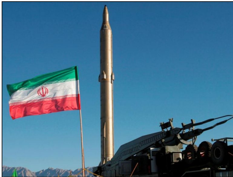
Figur 6.9 Sejil klar for oppskytning fra en mobil rampe i november 2008. Legg merke til det "trikoniske" nesepartiet. (Scanpix - AP Photo - Fars News Agency - Vahid Reza Alaei.)
