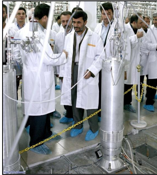
Figur 6.5 Trolig en IR-3-sentrifuge med delvis montert kjølevikling. (Bildet er tatt under presidentens besøk i Natanz i april 2008, og er hentet fra presidentens internettside [241].)
