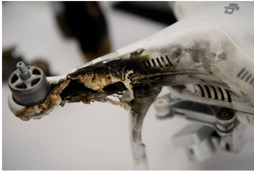
Figur 4.4 Drone skutt ned med laser. Fra test i april 2019 [25]
