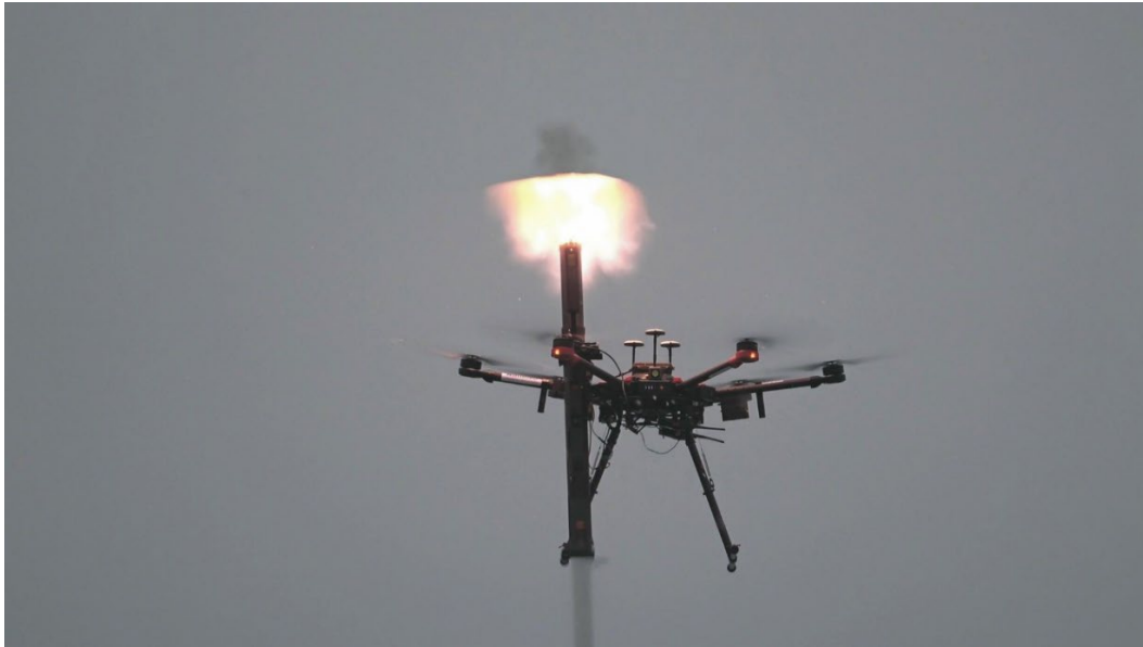
Figur 5.3 Avfiring av M72 panservernvåpen montert på FPV-drone. Foto: Nammo.
