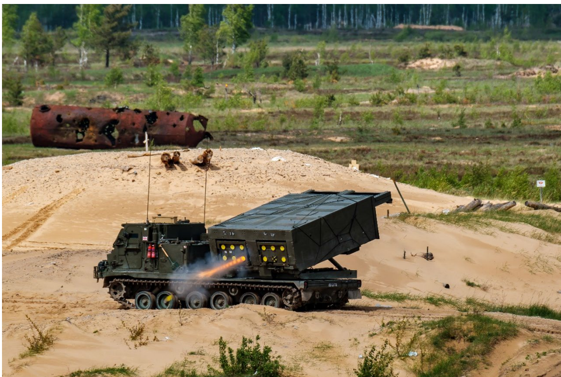
Figur 9.1 MLRS (Multiple Launch Rocket System) rakettartillerisystem montert på et beltegående chassis, Latvia mai 2022. Foto: Shutterstock / Karlis Dambrans / NTB
