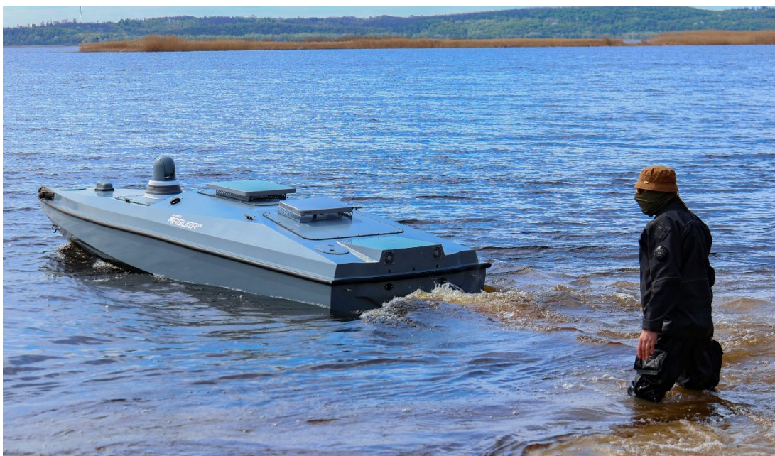
Figur 4.1 Magura V5 maritim overflatedrone. Foto: Pavlo Bahmut / NTB.
