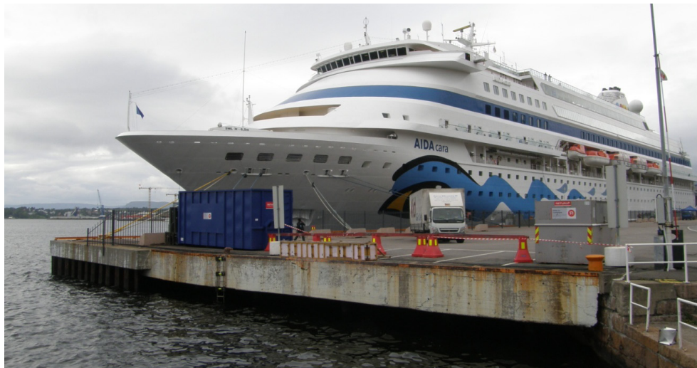
Figur 4.9 AidaCara og en del av kaien som gir variert tilbakespredning. På kaikanten nede til høyre ses en av de utplasserte radarreflektorene
