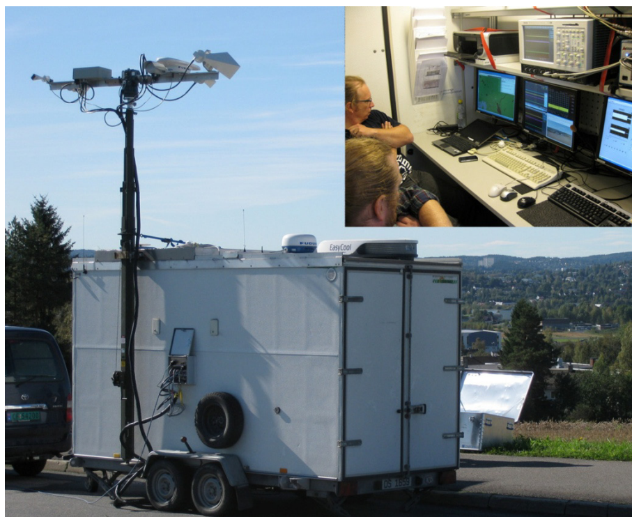
Figur 4.6 Prosjekt OPEK II sitt måleutstyr. En av antennene er rettet mot flybanen til PicoSAR og en annen mot målområdet
