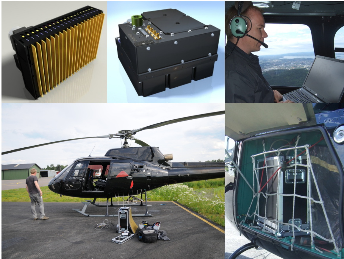
Figur 2.1 PicoSAR i helikopter. Øverst fra venstre: Antenne, prosesseringsenhet og styring fra bærbar PC. Nederst montering i helikopteret. Antennen og prosesseringsenheten er montert i en kasse som festes i helikopterets bagasjerom. Radaren kan operere mens kassen og bagasjeromsluken er lukket ettersom radarsignalet passerer vegger av tre og glassfiber uten stor dempning
