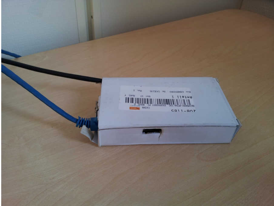
Figur 3.2 Etter at Raspberry Pi er installert, trenger den kun strøm og nettverk.
