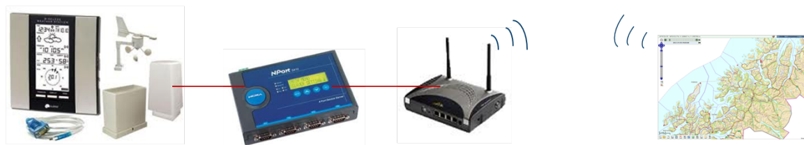
Figur 2.4 Datakjede fra værstasjon (WS-2355) til server. Fra venstre: Værstasjon, NPort, ICE-modem, innsynsløsningen på server.
