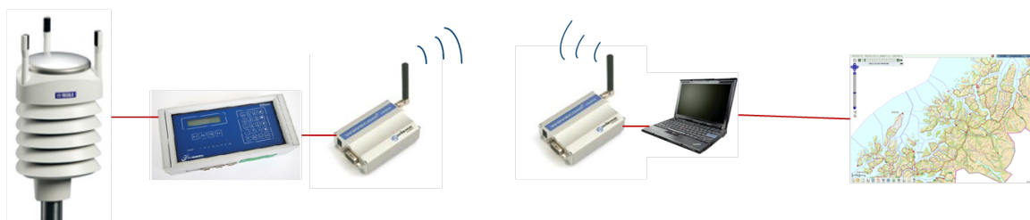
Figur 2.2 Datakjede fra værstasjon (WXT-520) til server. Fra venstre: Værstasjon, feltstasjon med modem, mottaker-PC med modem, innsynsløsningen på server.
