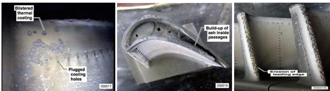
Figur 2.2 Effekten av vulkansk aske på flymotorer (Foto: NASA/TM-2003-212030)
