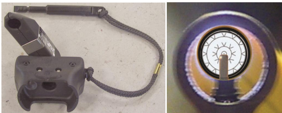
Figur 5.9 SAAD og korrekt siktebilde [11]
