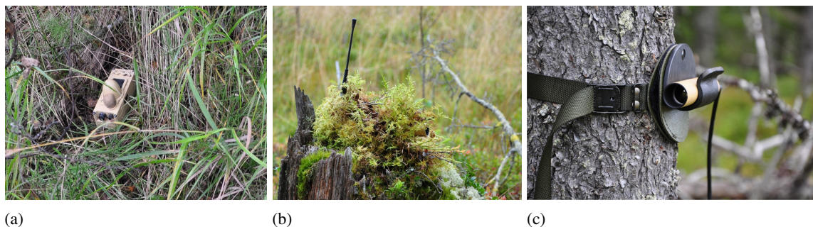
Figur 2.5 Exensor Flexnet består av (a) Seks UMRA mini seismisk detektorer, (b) et kamera (her kamouflert), og (c) tre passive IR detektorer
