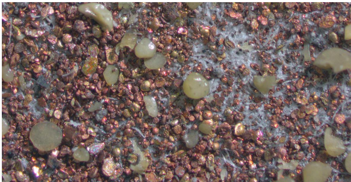
Figur 3.2 Partikler fra 5,56 mm frangible prosjektilet i fraksjonen større enn svevestøv. Prosjektilet kan til en viss grad ha fragmentert på vei ut av løpet og når det traff gummimembranen på vei ut av testkammeret. De lysegule partiklene er uforbrent krutt, mens de brunrøde partiklene er kobberpartikler.
