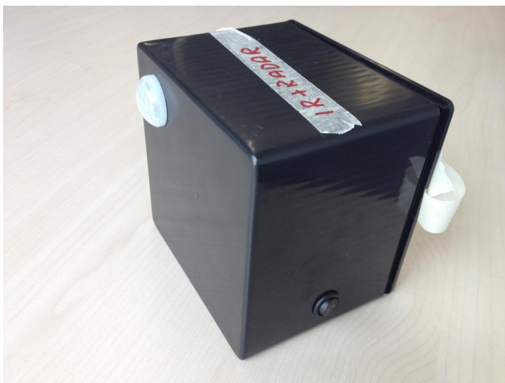
Figur 4.3 Viser utsiden av boks med IR-linse som er montert i boksens side.
